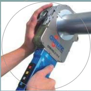
Control remoto incorporado en la empuñadura del resistente cabezal
