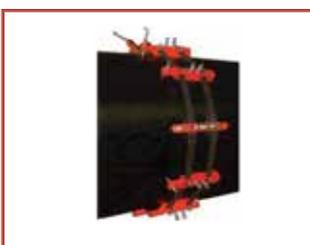
Los centradores de cadena doble están diseñados para la reforma y el centrado de tuberías y depósitos. Nuestros dispositivos especializados para servicio pesado de sujeción de doble cadena de bloqueo desempeñan fácilmente complicadas tareas de reformas. Se suministran para uso con acero al carbono o acero inoxidable y con cajas de almacenaje. Son las más fuertes del mercado.
