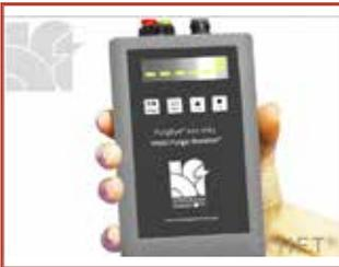
Especialmente diseñado para indicar los niveles de oxígeno del gas inerte para la purga de soldadura de titanio y otras aleaciones reactivas donde hay un libre flujo de los gases de escape con fines de medición. Incluye un sensor de respuesta rápida de larga duración, también disponible un software opcional PurgeLog™ pudiendo almacenar e imprimir resultados, gráficos, etc., para la gestión de calidad
