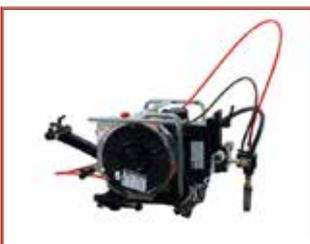
Sistema automático de corte de tuberías que incluye el carro de corte de montaje rápido para facilitar la instalación, el control remoto que incorpora la velocidad del carro, las funciones de dirección y de inicio/stop, un control motor con microprocesador y potenciómetro de cuatro posiciones.
