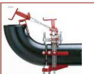
Los centradores exteriores con cadena Wizard son ligeros y fáciles de utilizar. Para alinear y reformar ligeramente los tubos, pueden adaptarse a una amplia gama de tamaños, pudiendo soldar toda la circunferencia del tubo sin retirar el centrador.
