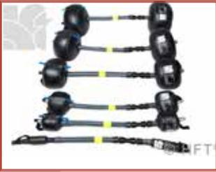
Sistema compuesto por dos bolsas protegidas conectadas por un tubo de purga de gas inerte. El gas purga tanto aire como gases y vapores no deseados, expulsándolos fuera del espacio que queda entre las bolsas e introduciendo el gas a través de una única válvula. Fácil y rápido de instalar, reduce el volumen de gas inerte a utilizar, para todos los grados de acero inoxidable y dúplex, interiores pulidos, metales exóticos y aleaciones.
