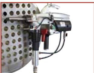
Máquina ideal para el refrentado de los tubos de intercambiadores de color y para recortar los tubos de las paredes de los intercambiadores. Sistema totalmente automatizado de fijación de máquina al tubo y avance automático de la herramienta.
