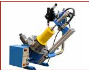
Máquinas en diseño de banco. Hay una amplia gama de componentes para crear una gran flexibilidad en su sistema de soldadura automática. Se pueden cambiar las piezas fácilmente consiguiendo minimizar el tiempo de instalación. La capacidad especial del sistema EZ Arc le ayuda a producir soldaduras circunferenciales de alta calidad y proporciona las ventajas de una rápida recuperación del costo, de la seguridad y la reducción de la fatiga del trabajador.
