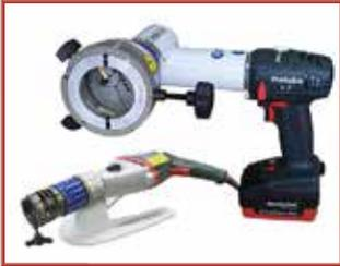
Máquinas para refrentar y para biselar tubos inoxidables de paredes delgadas y accesorios para tubos de tamaño reducido, portátiles y ligeras para un uso móvil y seguro. Cortes en ángulo recto y sin rebabas, biselado (30°/35°) posible mediante un soporte especial, placa giratoria con dos filos de corte y revestimiento de alto rendimiento, función de avance con escala milimétrica para un resultado óptimo, motor eléctrico con control de revoluciones.
