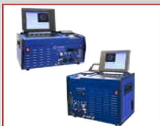
Generadores de soldadura orbital compactos controlados por ordenador. Además de la autoprogramación a introducir sólo el diámetro de tubo, espesor de pared, material y tipo de gas, los modelos Orbimat CA también poseen la última novedad, el “Flow Force”, para reducir los tiempos de prepurga cuando los cabezales de soldadura son cerrados, en los modelos estándar y el módulo control BUP opcional, permite optimizar la presión de purga interna durante el ciclo de soldadura.
