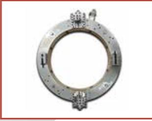
Es un sistema portátil de corte y biselado de tuberías de montaje externo. Se abre fácilmente para su montaje alrededor del diámetro exterior de la tubería en línea. Con un diseño de muy alta resistencia, puede accionarse por electricidad, aire o potencia hidráulica y ofrece requisitos mínimos de espacio.
