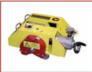
Tronzadora biseladora portátil capaz de cortar y biselar en frío simultáneamente, mecanizando todos los materiales de tuberías con diámetro exterior desde 152,4mm hasta 1829,0mm.
