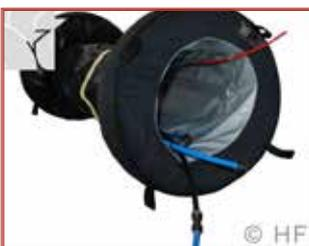
Al precalentar los aceros de alta resistencia que contienen en su aleación, elementos tales como Cr, V y Mo, se requiere purga de Argón en su interior durante la soldadura, para evitar la oxidación e impurezas, que llevarían a la fisuración y posterior rotura. Este sistema de purga de tubos es la versión resistente a altas temperaturas, soportan alrededor de 300°C durante períodos de hasta 24 horas.
