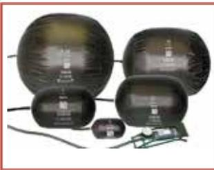
Es la manera sencilla de evitar la entrada de gas o líquido en una tubería o conducto. Disponibles en varios formatos, (esféricas, cilíndricas, rectangulares, etc.) y tamaños, desde 2" hasta 96" (50mm- 2438mm) en graduaciones de 1" (25mm). Hechas de caucho natural, cubiertas de nylon recubierto con poliuretano para evitar la generación de electricidad estática.
