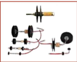
Ha sido diseñado tanto para reducir el consumo del gas inerte como para reducir el tiempo de purga. El gas se propaga a través de un difusor situado en la manguera y sale a través de los orificios de escape situados en la primera unidad de disco doble. Este proceso proporciona un caudal de gas uniforme, sin turbulencias, minimizando el riesgo de oxígeno y logrando un tiempo de purga extremadamente corto.
