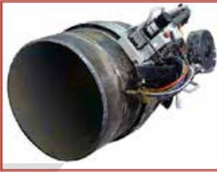
Sistema automático de soldadura orbital de tuberías con alimentador de hilo integrado, incluye el carro de soldadura 40IPM, con un sistema de montaje rápido que facilita su instalación. El Pipe Kat viene también equipado con oscilador lineal con amplitud de onda graduable, con ajuste de la línea central de la unión de soldadura y todas las funciones electrónicas motorizadas incorporan ajustes de desplazamiento. Con cuadro de control principal y control remoto.
