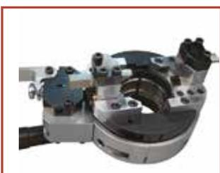
Son las más pequeñas y compactas de las series "split frame". Las SDSF están diseñadas para el corte y biselado de tuberías de acero al carbono y sus aleaciones: Hastelloy e Inconel y otros materiales exóticos; encajándolas en tuberías en línea o deslizándolas por los extremos abiertos de las mismas.
