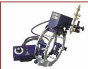
Los carros portátiles de corte de tuberías RSV disponen de un sistema de sujeción rápido para su fijación en cualquier punto de la tubería. La herramienta de corte puede ser inclinada hasta 45° y está equipada con ajuste vertical y horizontal. Sistema de movimiento manual o motorizado.
