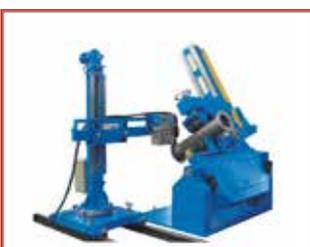
Este equipo combina las ventajas de un posicionador con las de muchas máquinas de soldar, puesto que permite ejecutar soldaduras de bridas para tubos en posiciones especiales. Este equipo puede girar 45° y permite una rotación de 360°. Combinación de soldadura de tuberías cortas, medianas y largas. La velocidad de rotación se ajusta mediante un variador. Es la mejor opción para la soldadura automática de bridas de tubos.
