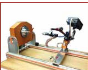
Desarrollo y fabricación de cabezales de soldadura orbital con aportador de hilo, para el sector de la aeronáutica con dimensiones especiales, capacidad de Ø O.D de 20 a 170mm y espesores desde 0,4 mm en calidad de material base tal como INCONE, TITANIO, ALUMINIO, ETC
