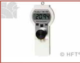
Con su innovador botón pulsador de auto calibración el PurgEye™ 100 permite al usuario poder calibrar a nivel atmosférico y otra vez, en la lectura mas baja del nivel de oxígeno para una mayor precisión. El monitor PurgEye™ 100 lleva a cabo esta tarea indicando los niveles de oxígeno de hasta 0,01% (100 ppm). Con indicador de sensor y batería baja.
