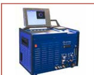
Controlado por ordenador con control del voltaje del arco (AVC) y oscilación (OSC). El nuevo AVC calcula y programa automáticamente la longitud del arco en mm según las características de la tensión de la corriente a fin de evitar pérdidas de tiempo al calcular la tensión de arco necesaria según cambie la potencia de soldadura. Durante la oscilación (OSC) cada tiempo de retardo en los extremos se puede sincronizar con los parámetros de pulso alto.
