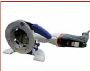
Máquinas refrentadoras de tubos de acero inoxidable de paredes delgadas, que además de reunir las características de su gama de menor rango, su sistema de cámara con visor permite trabajar de forma limpia y segura, biselado de 45°/35°, con sistema QTC® de cambio rápido de herramienta.
