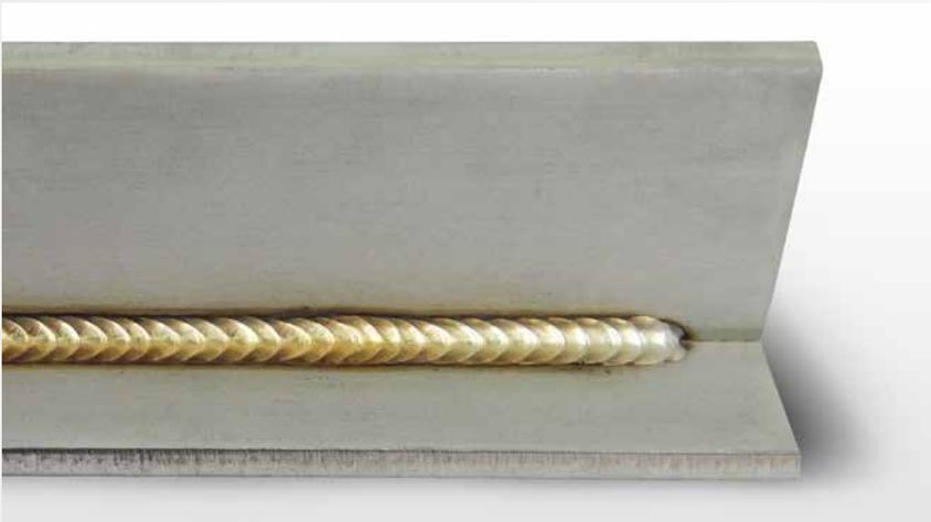
Pulsos TIG: soldadura en ángulo, posición PB
