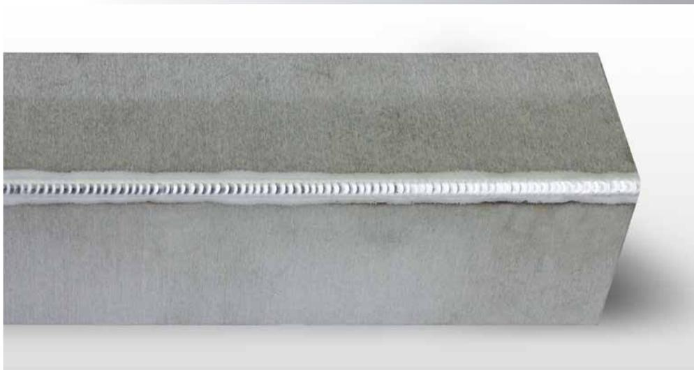
Especial AC: soldadura de esquina exterior, 3 mm
