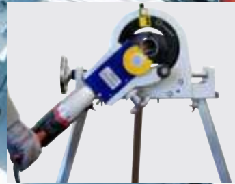
Corte de tubos y codos de acero inoxidable de paredes delgadas
